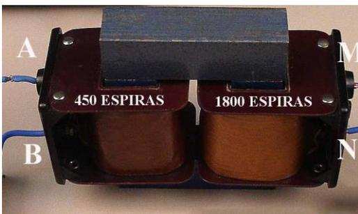
113. En la foto,  $V_{AB}$  está conectado a un generador de 50V de corriente alterna, por ello se podrá asegurar que  $V_{MN}$  será aproximadamente de:
